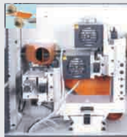
Gruppo antischeggia + doppio truciolatore (al posto del gruppo COMBI) Antichipping+double hogger unit (instead of COMBI unit)
